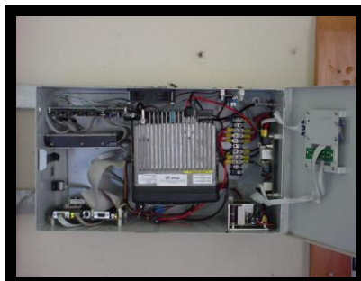
Figura 5.- Servidor de correo electrónico vía radio con pasarela telefónica.
