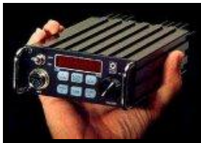
Figura 10.- Transceptor de radio HF Q-MAC ® incluido en el servidor EHAS.
