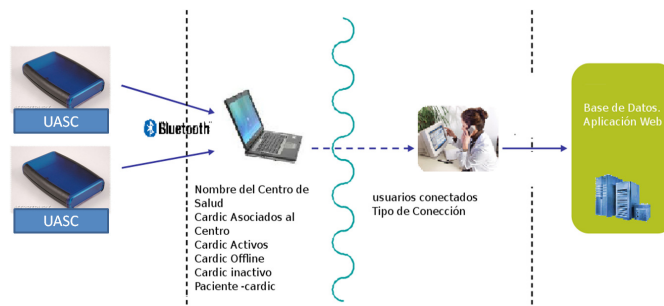
Figura 0.5: Estructura general de transmisión de información de Tele-ECG.
